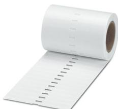
Etikett, ablösbar, Rolle, weiß, unbeschriftet, beschriftbar mit: THERMOMARK E.300 (D)/600 (D), THERMOMARK ROLL 2.0, THERMOMARK ROLL, THERMOMARK ROLL X1, THERMOMARK ROLLMASTER 300/600, THERMOMARK X1.2, Montageart: kleben, Anzahl der Einzelschilder: 2500, Textfeldhöhe: 5 mm, Textfeldbreite: 45 mm
