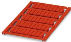
Leiterbezeichnungshülse, Matte, rot, unbeschriftet, beschriftbar mit: BLUEMARK E.CARD, BLUEMARK ID COLOR, BLUEMARK ID, BLUEMARK CLED, THERMOMARK PRIME 2.0, THERMOMARK PRIME, THERMOMARK CARD 2.0, THERMOMARK CARD, TOPMARK NEO, TOPMARK LASER, Kabeldurchmesserbereich: 2,5 ... 4,7 mm, Montageart: aufschieben, für Klemmenbreite: 5,2 mm, Anzahl der Einzelschilder: 45, Textfeldhöhe: 5,5 mm, Textfeldbreite: 12 mm
