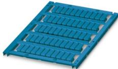
Leiterbezeichnungshülse, Matte, bestellbar: mattenweise, blau, beschriftet nach Kundenangaben, Kabeldurchmesserbereich: 1,5 ... 3,2 mm, Montageart: aufschieben, für Klemmenbreite: 5,2 mm, Anzahl der Einzelschilder: 55, Textfeldhöhe: 4 mm, Textfeldbreite: 12 mm
