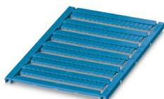
Marker für Klemmen, Matte, blau, unbeschriftet, beschriftbar mit: BLUEMARK E.CARD, BLUEMARK ID COLOR, BLUEMARK ID, BLUEMARK CLED, THERMOMARK PRIME 2.0, THERMOMARK PRIME, THERMOMARK CARD 2.0, THERMOMARK CARD, TOPMARK NEO, TOPMARK LASER, Montageart: verrasten, für Klemmenbreite: 3,5 mm, Anzahl der Einzelschilder: 108, Textfeldhöhe: 4,7 mm, Textfeldbreite: 2,7 mm
