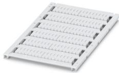
Marker für Klemmen, Matte, weiß, unbeschriftet, beschriftbar mit: BLUEMARK E.CARD, BLUEMARK ID COLOR, BLUEMARK ID, BLUEMARK CLED, THERMOMARK PRIME 2.0, THERMOMARK PRIME, THERMOMARK CARD 2.0, THERMOMARK CARD, TOPMARK NEO, TOPMARK LASER, Montageart: verrasten, für Klemmenbreite: 3,5 mm, Anzahl der Einzelschilder: 102, Textfeldhöhe: 10,5 mm, Textfeldbreite: 2,95 mm
