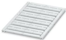
Marker für Klemmen, Matte, weiß, unbeschriftet, beschriftbar mit: BLUEMARK E.CARD, BLUEMARK ID COLOR, BLUEMARK ID, BLUEMARK CLED, THERMOMARK PRIME 2.0, THERMOMARK PRIME, THERMOMARK CARD 2.0, THERMOMARK CARD, TOPMARK NEO, TOPMARK LASER, Montageart: verrasten, für Klemmenbreite: 16 mm, Anzahl der Einzelschilder: 24, Textfeldhöhe: 4,7 mm, Textfeldbreite: 15,2 mm
