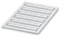
Marker für Klemmen, Matte, weiß, unbeschriftet, beschriftbar mit: BLUEMARK E.CARD, BLUEMARK ID COLOR, BLUEMARK ID, BLUEMARK CLED, THERMOMARK PRIME 2.0, THERMOMARK PRIME, THERMOMARK CARD 2.0, THERMOMARK CARD, TOPMARK NEO, TOPMARK LASER, Montageart: verrasten, für Klemmenbreite: 12 mm, Anzahl der Einzelschilder: 30, Textfeldhöhe: 4,7 mm, Textfeldbreite: 11,2 mm
