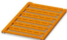
Marker für Klemmen, Matte, orange, unbeschriftet, beschrifftbar mit: BLUEMARK E.CARD, BLUEMARK ID COLOR, BLUEMARK ID, BLUEMARK CLED, THERMOMARK PRIME 2.0, THERMOMARK PRIME, THERMOMARK CARD 2.0, THERMOMARK CARD, TOPMARK NEO, TOPMARK LASER, Montageart: verrasten, für Klemmenbreite: 12 mm, Anzahl der Einzelschilder: 30, Textfeldhöhe: 4,7 mm, Textfeldbreite: 11,2 mm
