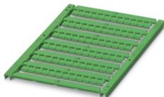
Marker für Klemmen, Matte, grün, unbeschriftet, beschriftbar mit: BLUEMARK E.CARD, BLUEMARK ID COLOR, BLUEMARK ID, BLUEMARK CLED, THERMOMARK PRIME 2.0, THERMOMARK PRIME, THERMOMARK CARD 2.0, THERMOMARK CARD, TOPMARK NEO, TOPMARK LASER, Montageart: verrasten, für Klemmenbreite: 5,2 mm, Anzahl der Einzelschilder: 72, Textfeldhöhe: 4,7 mm, Textfeldbreite: 4,4 mm
