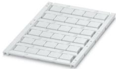
Marker für Klemmen, Matte, weiß, unbeschriftet, beschriftbar mit: BLUEMARK E.CARD, BLUEMARK ID COLOR, BLUEMARK ID, BLUEMARK CLED, THERMOMARK PRIME 2.0, THERMOMARK PRIME, THERMOMARK CARD 2.0, THERMOMARK CARD, TOPMARK NEO, TOPMARK LASER, Montageart: verrasten, für Klemmenbreite: 12 mm, Anzahl der Einzelschilder: 30, Textfeldhöhe: 9,6 mm, Textfeldbreite: 10,8 mm
