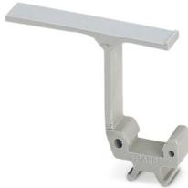
Gruppenbezeichnungsschild, einrastbar in Klemmenmitte für Schraub-, Zugfeder-, Push-in- und Schnellanschlussklemmen, beschriftbar mit einem Etikett 24 x 4 mm, oder manuell mit dem B-STIFT, im Fußteil mit ZB 5
