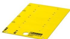
Gerätemarker, Karte, gelb, unbeschriftet, beschriftbar mit: BLUEMARK ID COLOR, BLUEMARK ID, THERMOMARK PRIME, THERMOMARK CARD 2.0, THERMOMARK CARD, THERMOMARK PRIME 2.0, Montageart: schrauben, nieten, Anzahl der Einzelschilder: 4, Textfeldhöhe: 30 mm, Textfeldbreite: 50 mm
