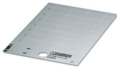
Kunststoffschild, Karte, silber, unbeschriftet, beschriftbar mit: BLUEMARK ID COLOR, BLUEMARK ID, THERMOMARK PRIME, THERMOMARK CARD 2.0, THERMOMARK CARD, THERMOMARK PRIME 2.0, Montageart: kleben, Anzahl der Einzelschilder: 21, Textfeldhöhe: 18 mm, Textfeldbreite: 27 mm
