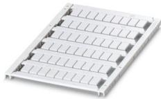
Marker für Klemmen, zur Beschriftung von Cabur Klemmen, Matte, weiß, unbeschriftet, beschriftbar mit: BLUEMARK E.CARD, BLUEMARK ID COLOR, BLUEMARK ID, THERMOMARK PRIME 2.0, THERMOMARK PRIME, THERMOMARK CARD 2.0, THERMOMARK CARD, TOPMARK NEO, TOPMARK LASER, Montageart: verrasten, für Klemmenbreite: 6,5 mm, Anzahl der Einzelschilder: 54, Textfeldhöhe: 10 mm, Textfeldbreite: 6 mm
