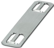
Edelstahlschild, bestellbar: stückweise, silberfarben, beschriftet nach Kundenangaben, Kabeldurchmesserbereich: 1 ... 63 mm, Montageart: Kabelbindermontage, Textfeldhöhe: 9 mm, Textfeldbreite: 23 mm
