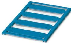
Kabelmarker, Matte, blau, unbeschriftet, beschriftbar mit: BLUEMARK E.CARD, BLUEMARK ID COLOR, BLUEMARK ID, BLUEMARK CLED, PLOTMARK, CMS-P1-PLOTTER, Montageart: Kabelbindermontage, Kabeldurchmesser: > 7 mm, Anzahl der Einzelschilder: 4, Textfeldhöhe: 15 mm, Textfeldbreite: 44 mm
