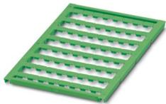
Marker für Klemmen, Matte, grün, unbeschriftet, beschriftbar mit: BLUEMARK ID, BLUEMARK ID COLOR, BLUEMARK CLED, PLOTMARK, CMS-P1-PLOTTER, Montageart: verrasten, für Klemmenbreite: 8 mm, Anzahl der Einzelschilder: 64, Textfeldhöhe: 5,2 mm, Textfeldbreite: 7,65 mm
