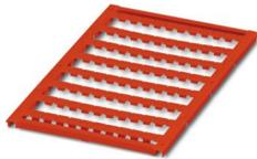
Marker für Klemmen, Matte, rot, unbeschriftet, beschriftbar mit: BLUEMARK E.CARD, BLUEMARK ID COLOR, BLUEMARK ID, BLUEMARK CLED, PLOTMARK, CMS-P1-PLOTTER, Montageart: verrasten, Anzahl der Einzelschilder: 80, Textfeldhöhe: 5,2 mm, Textfeldbreite: 5,45 mm
