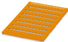
Marker für Klemmen, Matte, orange, unbeschriftet, beschriftbar mit: BLUEMARK ID, BLUEMARK ID COLOR, BLUEMARK CLED, PLOTMARK, CMS-P1-PLOTTER, Montageart: verrasten, für Klemmenbreite: 6 mm, Anzahl der Einzelschilder: 80, Textfeldhöhe: 9,7 mm, Textfeldbreite: 5,55 mm
