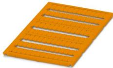
Marker für Klemmen, Matte, orange, unbeschriftet, beschriftbar mit: BLUEMARK ID, BLUEMARK ID COLOR, BLUEMARK CLED, PLOTMARK, CMS-P1-PLOTTER, Montageart: verrasten, für Klemmenbreite: 5 mm, Anzahl der Einzelschilder: 96, Textfeldhöhe: 9,7 mm, Textfeldbreite: 4,55 mm
