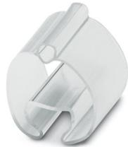
Ader-Bezeichnungsträger, transparent, unbeschriftet, Kabeldurchmesserbereich: 14 ... 22 mm, Montageart: aufschieben, Textfeldhöhe: 4 mm, Textfeldbreite: 18 mm
