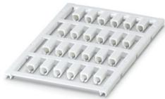
Leitermarker, Matte, weiß, unbeschriftet, beschriftbar mit: BLUEMARK E.CARD, BLUEMARK ID COLOR, BLUEMARK ID, BLUEMARK CLED, PLOTMARK, CMS-P1-PLOTTER, Kabeldurchmesserbereich: 3,6 ... 4,9 mm, Montageart: aufschieben, Anzahl der Einzelschilder: 24, Textfeldhöhe: 5 mm, Textfeldbreite: 12 mm
