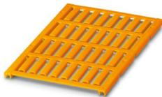
Leitermarker, Matte, orange, unbeschriftet, beschriftbar mit: BLUEMARK ID COLOR, BLUEMARK ID COLOR, BLUEMARK CLED, PLOTMARK, CMS-P1-PLOTTER, Kabeldurchmesserbereich: 2,9 ... 3,6 mm, Montageart: aufschieben, Anzahl der Einzelschilder: 32, Textfeldhöhe: 4,5 mm, Textfeldbreite: 21 mm
