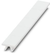
Zackband, Streifen, weiß, unbeschriftet, beschriftbar mit: PLOTMARK, CMS-P1-PLOTTER, Montageart: verrasten, für Klemmenbreite: 16 mm, Anzahl der Einzelschilder: 50, Textfeldhöhe: 10,5 mm, Textfeldbreite: 16 mm
