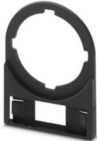
Schildchenträger, einsetzbar für alle Taster und Schalter mit 22 mm Durchmesser, schwarz, unbeschriftet, Montageart: schrauben, nieten, Durchmesser: 23 mm, Textfeldhöhe: 8 mm, Textfeldbreite: 27 mm
