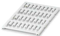
Leitermarker, Matte, weiß, unbeschriftet, beschriftbar mit: BLUEMARK E.CARD, BLUEMARK ID COLOR, BLUEMARK ID, BLUEMARK CLED, PLOTMARK, CMS-P1-PLOTTER, Kabeldurchmesserbereich: 2,9 ... 3,6 mm, Montageart: aufschieben, Anzahl der Einzelschilder: 32, Textfeldhöhe: 4,5 mm, Textfeldbreite: 12 mm
