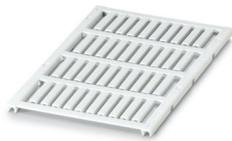
Leitermarker, Matte, weiß, unbeschriftet, beschriftbar mit: BLUEMARK E.CARD, BLUEMARK ID COLOR, BLUEMARK ID, BLUEMARK CLED, PLOTMARK, CMS-P1-PLOTTER, Kabeldurchmesserbereich: 2,1 ... 2,9 mm, Montageart: aufschieben, Anzahl der Einzelschilder: 40, Textfeldhöhe: 3,5 mm, Textfeldbreite: 21 mm
