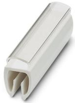
Ader-Bezeichnungsträger, transparent, unbeschriftet, Kabeldurchmesserbereich: 2,8 ... 4,4 mm, Montageart: aufclipsen, Textfeldhöhe: 4 mm, Textfeldbreite: 12 mm
