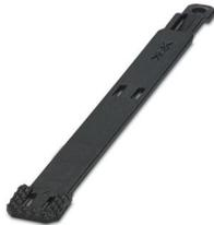
Träger für Leiterbezeichnungshülse, schwarz, unbeschriftet, Montageart: Kabelbindermontage, Kabeldurchmesser: > 16 mm, Textfeldhöhe: 10 mm, Textfeldbreite: 100 mm
