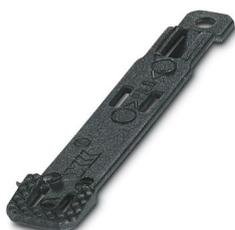
Träger für Leiterbezeichnungshülse, schwarz, unbeschriftet, Montageart: Kabelbindermontage, Kabeldurchmesser: > 16 mm, Textfeldhöhe: 10 mm, Textfeldbreite: 70 mm
