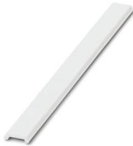
Zackband flach, bestellbar: streifenweise, weiß, beschriftet nach Kundenangaben, Montageart: verrasten in flacher Schildchennut, für Klemmenbreite: 15 mm, Anzahl der Einzelschilder: 5, Textfeldhöhe: 15,1 mm, Textfeldbreite: 5,15 mm
