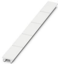
Schützschild-Zackband, bestellbar: streifenweise, weiß, beschriftet nach Kundenangaben, Montageart: verrasten in flacher Schildchennut, für Klemmenbreite: 20 mm, Textfeldhöhe: 8 mm, Textfeldbreite: 20 mm
