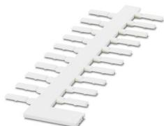
Kabelmarker, bestellbar: streifenweise, weiß, beschriftet nach Kundenangaben, Kabeldurchmesserbereich: 0,6 ... 7 mm, Montageart: auffädeln, Textfeldhöhe: 4 mm, Textfeldbreite: 10 mm
