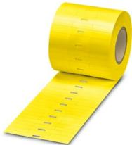
Einsteckschild, bestellbar: zeilenweise, gelb, beschriftet nach Kundenangaben, Kabeldurchmesserbereich: 10 ... 25 mm, Montageart: einlegen, Textfeldhöhe: 8 mm, Textfeldbreite: 29 mm
