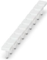
Bezeichnungsnagel-Zackband, Streifen, bestellbar: streifenweise, weiß, beschriftet nach Kundenangaben, Montageart: stecken, für Klemmenbreite: 5,2 mm, Anzahl der Einzelschilder: 10, Textfeldhöhe: 4 mm, Textfeldbreite: 4 mm
