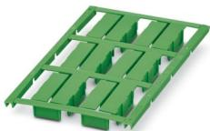
Leitermarker, Matte, grün, unbeschriftet, beschriftbar mit: BLUEMARK E.CARD, BLUEMARK ID COLOR, BLUEMARK ID, BLUEMARK CLED, PLOTMARK, CMS-P1-PLOTTER, Kabeldurchmesserbereich: 5 ... 7,5 mm, Montageart: aufclipsen, Anzahl der Einzelschilder: 6, Textfeldhöhe: 8 mm, Textfeldbreite: 30 mm
