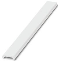
Zackband flach, Streifen, weiß, unbeschriftet, beschriftbar mit: PLOTMARK, CMS-P1-PLOTTER, Montageart: verrasten, für Klemmenbreite: 12 mm, Anzahl der Einzelschilder: 500, Textfeldhöhe: 12,15 mm, Textfeldbreite: 5,15 mm
