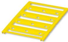
Kabelmarker, Matte, gelb, unbeschriftet, beschriftbar mit: BLUEMARK E.CARD, BLUEMARK ID COLOR, BLUEMARK ID, BLUEMARK CLED, PLOTMARK, CMS-P1-PLOTTER, Kabeldurchmesserbereich: 6 ... 136 mm, Montageart: Kabelbindermontage, Kabeldurchmesser: > 6 mm, Anzahl der Einzelschilder: 4, Textfeldhöhe: 11 mm, Textfeldbreite: 60 mm
