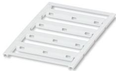
Kabelmarker, Matte, weiß, unbeschriftet, beschriftbar mit: BLUEMARK E.CARD, BLUEMARK ID COLOR, BLUEMARK ID, BLUEMARK CLED, PLOTMARK, CMS-P1-PLOTTER, Kabeldurchmesserbereich: 6 ... 136 mm, Montageart: Kabelbindermontage, Kabeldurchmesser: > 6 mm, Anzahl der Einzelschilder: 4, Textfeldhöhe: 11 mm, Textfeldbreite: 60 mm
