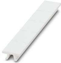
Zackband, Streifen, weiß, unbeschriftet, beschriftbar mit: PLOTMARK, CMS-P1-PLOTTER, Montageart: verrasten, für Klemmenbreite: 14 mm, Anzahl der Einzelschilder: 5, Textfeldhöhe: 10,5 mm, Textfeldbreite: 14 mm
