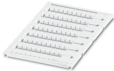
Marker für Klemmen, Matte, weiß, unbeschriftet, beschriftbar mit: BLUEMARK E.CARD, BLUEMARK ID COLOR, BLUEMARK ID, BLUEMARK CLED, PLOTMARK, CMS-P1-PLOTTER, Montageart: verrasten, für Klemmenbreite: 5,2 mm, Anzahl der Einzelschilder: 80, Textfeldhöhe: 7 mm, Textfeldbreite: 5 mm
