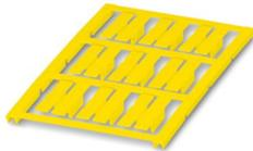
Leitermarker, Matte, gelb, unbeschriftet, beschriftbar mit: BLUEMARK E.CARD, BLUEMARK ID COLOR, BLUEMARK ID, BLUEMARK CLED, PLOTMARK, CMS-P1-PLOTTER, Kabeldurchmesserbereich: 2,8 ... 4,4 mm, Montageart: aufclipsen, Anzahl der Einzelschilder: 9, Textfeldhöhe: 5,5 mm, Textfeldbreite: 30 mm
