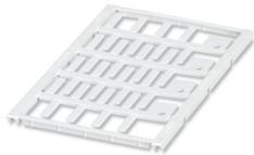
Leitermarker, Matte, weiß, unbeschriftet, beschriftbar mit: BLUEMARK E.CARD, BLUEMARK ID COLOR, BLUEMARK ID, BLUEMARK CLED, PLOTMARK, CMS-P1-PLOTTER, Kabeldurchmesserbereich: 0,6 ... 46 mm, Montageart: einschieben, Anzahl der Einzelschilder: 32, Textfeldhöhe: 4 mm, Textfeldbreite: 15 mm
