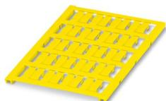
Leitermarker, Matte, gelb, unbeschriftet, beschriftbar mit: BLUEMARK E.CARD, BLUEMARK ID COLOR, BLUEMARK ID, BLUEMARK CLED, PLOTMARK, CMS-P1-PLOTTER, Kabeldurchmesserbereich: 1,9 ... 3,1 mm, Montageart: aufclipsen, Anzahl der Einzelschilder: 20, Textfeldhöhe: 4 mm, Textfeldbreite: 15 mm
