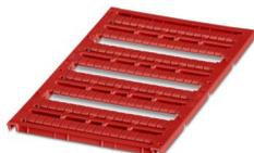
Marker für Klemmen, Matte, rot, unbeschriftet, beschriftbar mit: BLUEMARK E.CARD, BLUEMARK ID COLOR, BLUEMARK ID, BLUEMARK CLED, PLOTMARK, CMS-P1-PLOTTER, Montageart: verrasten, für Klemmenbreite: 4,2 mm, Anzahl der Einzelschilder: 120, Textfeldhöhe: 5,1 mm, Textfeldbreite: 3,6 mm
