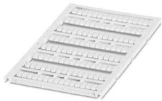
Marker für Klemmen, Matte, weiß, unbeschriftet, beschriftbar mit: BLUEMARK E.CARD, BLUEMARK ID COLOR, BLUEMARK ID, BLUEMARK CLED, PLOTMARK, CMS-P1-PLOTTER, Montageart: verrasten, für Klemmenbreite: 4,2 mm, Anzahl der Einzelschilder: 120, Textfeldhöhe: 5,1 mm, Textfeldbreite: 3,6 mm
