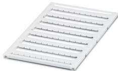
Marker für Klemmen, Matte, weiß, unbeschriftet, beschriftbar mit: BLUEMARK E.CARD, BLUEMARK ID COLOR, BLUEMARK ID, BLUEMARK CLED, PLOTMARK, CMS-P1-PLOTTER, Montageart: verrasten, für Klemmenbreite: 6,2 mm, Anzahl der Einzelschilder: 80, Textfeldhöhe: 5,1 mm, Textfeldbreite: 5,6 mm
