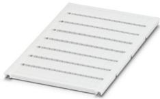
Marker für Klemmen, Matte, weiß, unbeschriftet, beschriftbar mit: BLUEMARK E.CARD, BLUEMARK ID COLOR, BLUEMARK ID, BLUEMARK CLED, PLOTMARK, CMS-P1-PLOTTER, Montageart: verrasten, für Klemmenbreite: 4,2 mm, Anzahl der Einzelschilder: 120, Textfeldhöhe: 10,5 mm, Textfeldbreite: 3,6 mm
