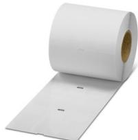
Kabelwickeletikett, Rolle, weiß, unbeschriftet, beschriftbar mit: THERMOMARK E.300 (D)/600 (D), THERMOMARK ROLL 2.0, THERMOMARK ROLL, THERMOMARK ROLL X1, THERMOMARK ROLMASTER 300/600, THERMOMARK X1.2, Kabeldurchmesserbereich: 6,1 ... 14,2 mm, Montageart: kleben, Kabeldurchmesser: ≤ 14,2 mm, Anzahl der Einzelschilder: 1500, Textfeldhöhe: 19,1 mm, Textfeldbreite: 25,4 mm
