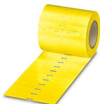
Einsteckschild, Rolle, gelb, unbeschriftet, beschriftbar mit: THERMOMARK E.300 (D)/600 (D), THERMOMARK ROLL 2.0, THERMOMARK ROLL, THERMOMARK ROLL X1, THERMOMARK ROLLMASTER 300/600, THERMOMARK X1.2, Kabeldurchmesserbereich: 1,5 ... 35 mm, Montageart: einschieben, Anzahl der Einzelschilder: 5000, Textfeldhöhe: 4 mm, Textfeldbreite: 23 mm
